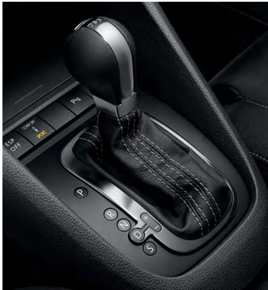
Das Doppelkupplungsgetriebe DSG wechselt in Hundertstelsekunden und ohne Zugkraftunterbrechung in den nächsten Gang und macht sportliches Beschleunigen möglich. Das 6-stufige Getriebe hilft durch seine Effizienz auch Kraftstoff zu sparen.
