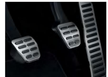
Die Pedalerie veredelt den vorderen Fußraum durch **Pedalkappen aus gebürstetem Edelstahl mit griffigem Antirutschbelag**.
