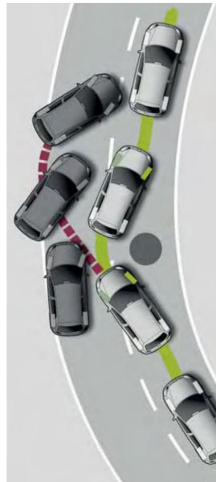
Das speziell auf die sportlichen Eigenschaften des neuen Golf R eingestellte Elektronische Stabilisierungsprogramm (ESP) verhindert in kritischen Fahrsituationen ein Ausbrechen des Fahrzeuges. So erreicht das Fahrzeug maximale Richtungsstabilität.
