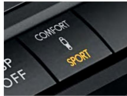
Die adaptive Fahrwerksregelung DCC stellt innerhalb von Millisekunden jeden Dämpfer individuell auf die Fahrbahn und die Fahrsituation ein. Per Knopfdruck entscheiden Sie, wie straff oder komfortabel das Fahrwerk abgestimmt sein soll.
