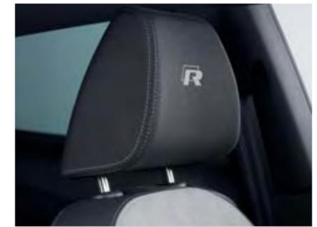
Die **Kopfstützen mit gesticktem R-Logo in Art Grey** sind vorn höhenverstellbar und sicherheitsoptimiert. Im Falle eines Aufpralls reduzieren sie den Abstand zwischen Kopf und Kopfstütze. Das Risiko einer Überdehnung der Nackenmuskulatur wird minimiert.
